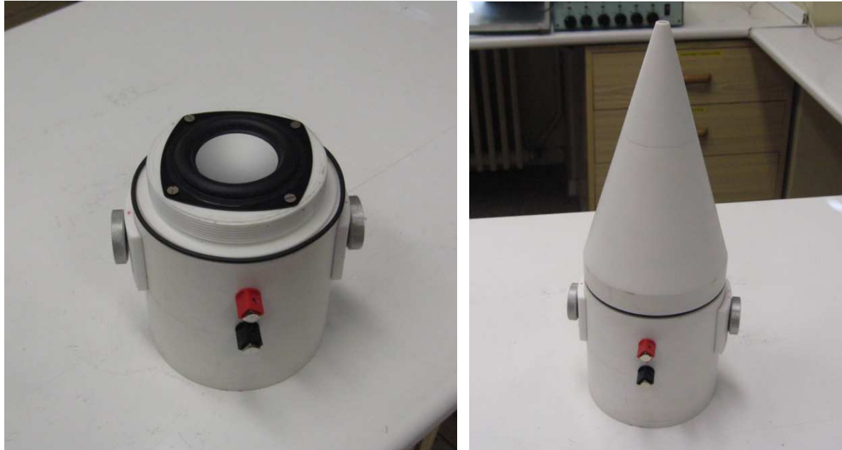
Figura 2: La Fuente puntual, antes (izquierda) y después (derecha) de insertar el cono con la apertura pequeña
