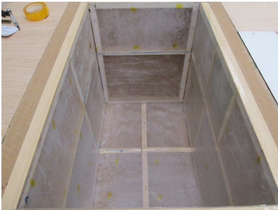
Figura 6: La cavidad abierta con las paredes interiores recubiertas de MPPs
